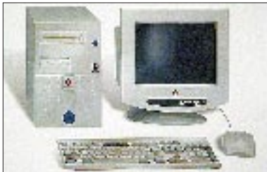
GO iP 100: Das Flaggschiff der neuen GO-Linie vom neu-erstandenen Commodore ist ein 100-MHz-Pentium mit Soundkarte, Giga-Platte und CD-ROM.
