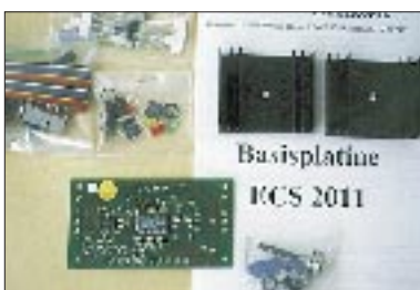
Die Basisplatine ECS 2011 bildet die Grundlage eines Akku-Schnellader-Bausatzes mit ECS-Ladecharakteristik
