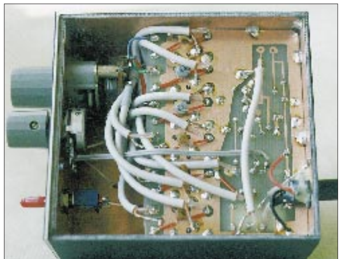
Bild 5: Innenansicht des Muster-Preselektors von unten. Auf der Leiterseite der Platine sind außer den Verbindungen zum Bandschalter u. a. noch die Koppelkondensatoren C2 der Bandfilter einzulöten.
