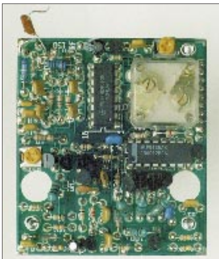
Bild 2: Unterseite der Analog-Leiterplatte. Unten rechts der Drehkondensator, oben rechts der Koppelkondensator zur HF-Buchse
